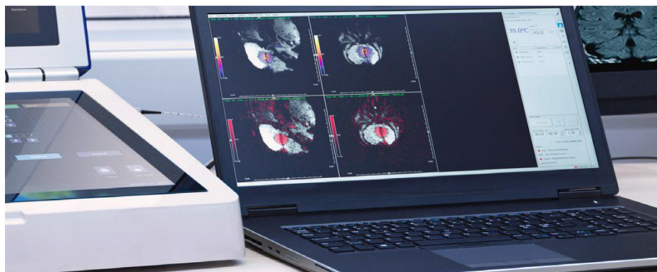
Bild 3: Thermoguide Workstation - visar temperatur och beräknad ablation för optimering av behandlingsresultat. Foto: CLS
